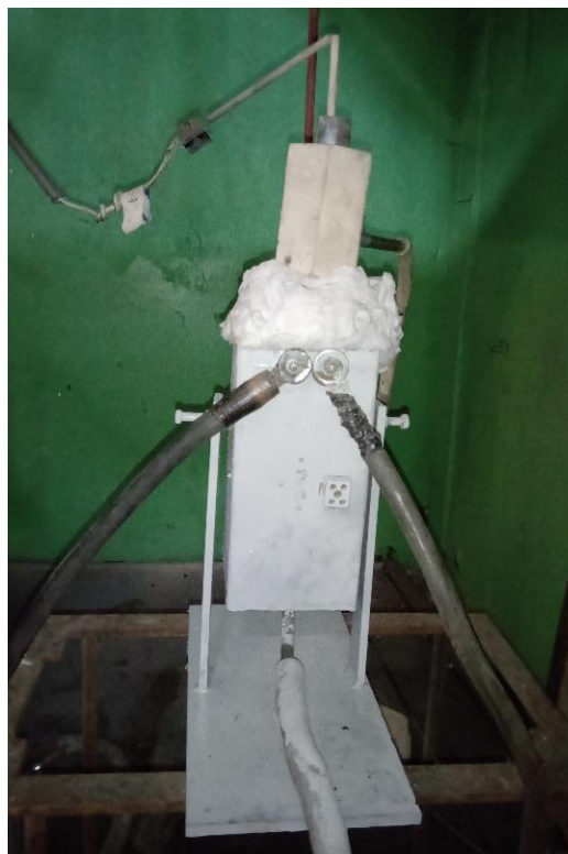
Рисунок 3. Внешний вид реактора с ЭТПС для нанесения защитного пироуглеродного покрытия
