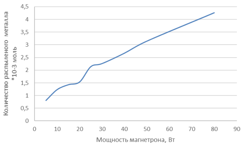
Рисунок 3. Изменение количества распыленного гафния в зависимости от мощности на магнетроне в аргон-азотной атмосфере
